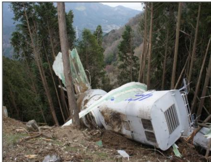
写真 1 タワー座屈・ブレード・ナセル脱落状況
