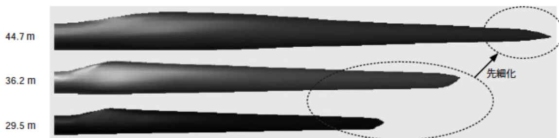
図5 スリム翼の採用
