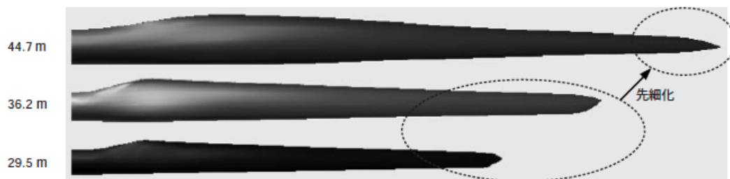
図5 スリム翼の採用
